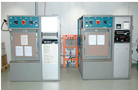
Bei Elastomeren wird eine Ozonalterung durchgeführt, welche wichtige Aussagen bezüglich der Eignung für den praktischen Einsatz erlaubt.
