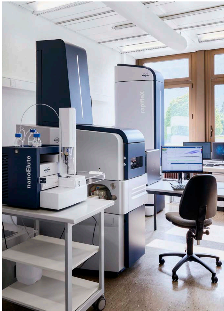
Das nano-LC-IMS-QTOF zur Detektion und Identifizierung von Toxinen.
