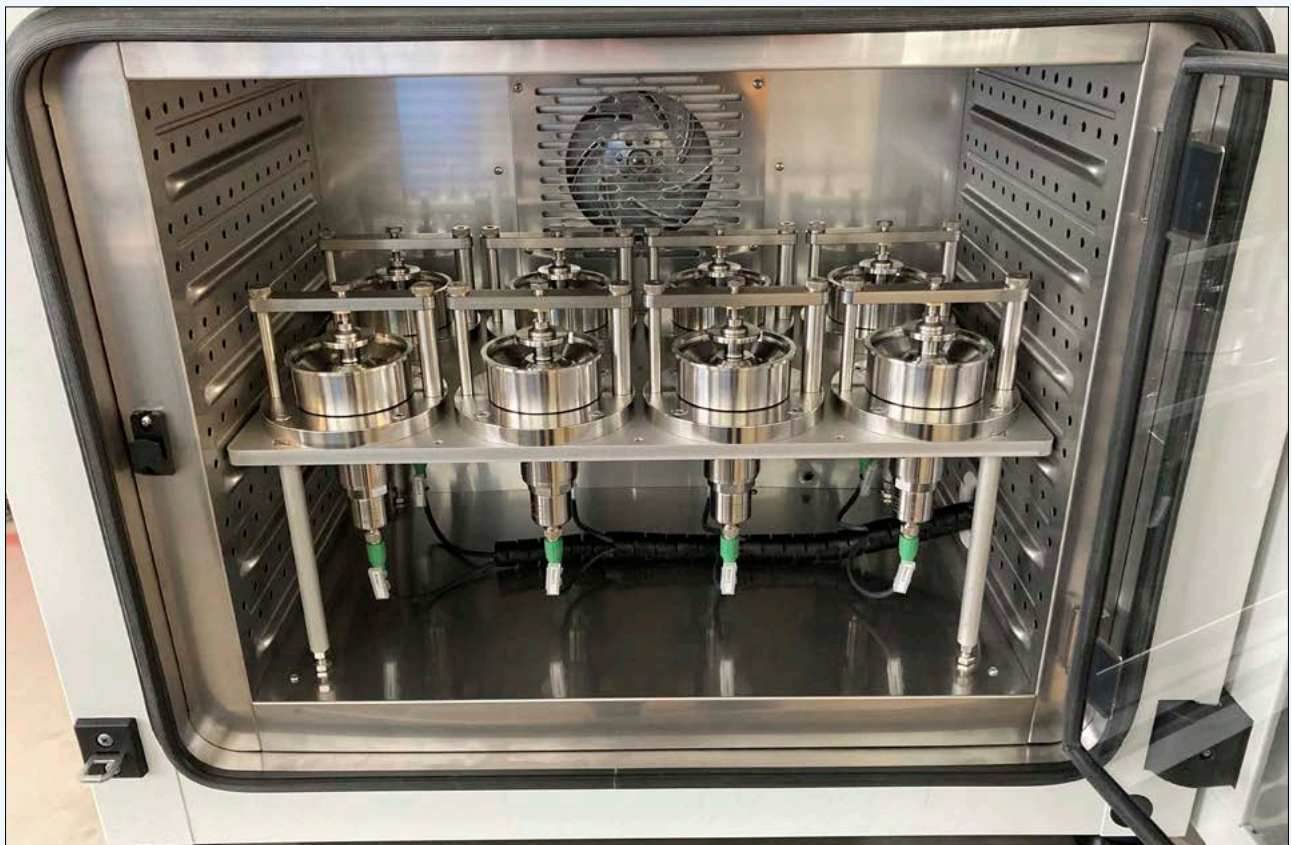
Réalisation des cellules de test du banc d'essais pour la mesure en temps réel de la résistance aux agents chimiques de combat des vêtements de protection contre l'ypérite liquide.
