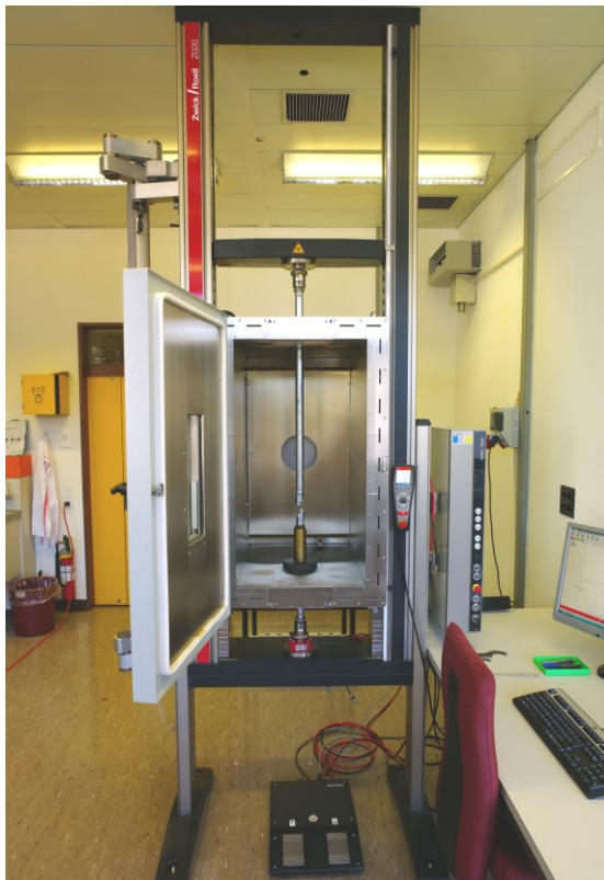
Bild 4: Zugprüfmaschine mit Temperierkammer
