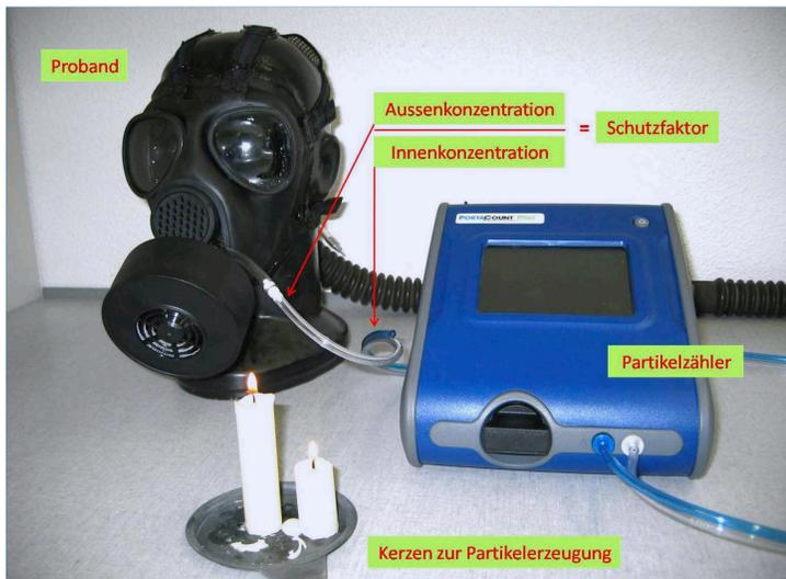
Aerosol-Test schematisch mit Prüfkopf
