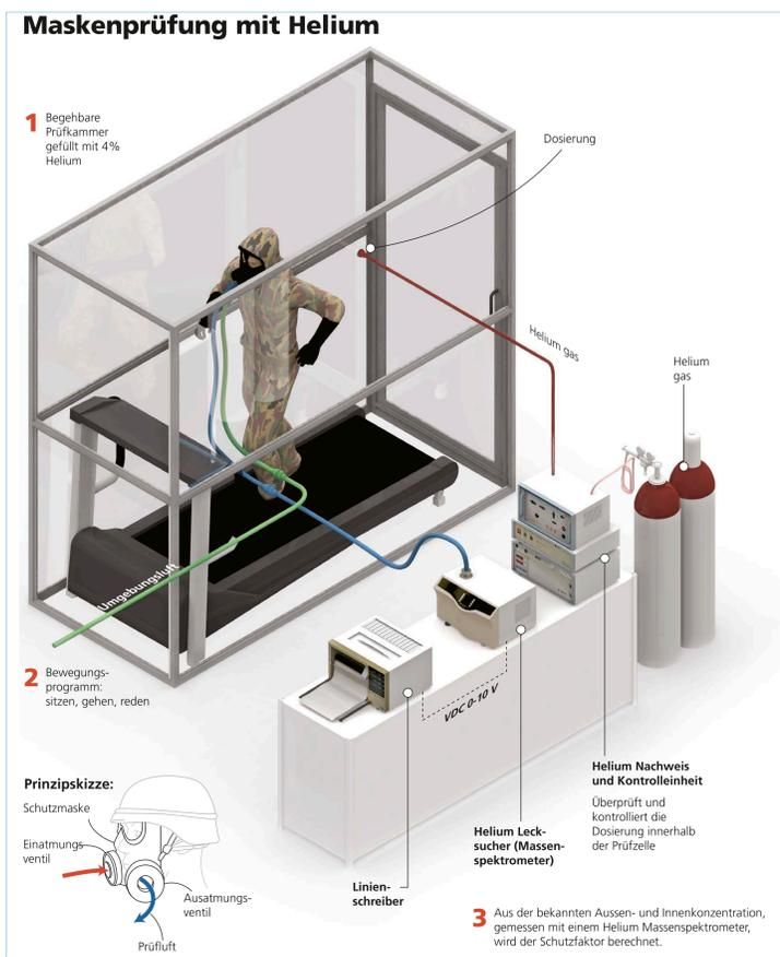
Prüfstand Helium Dichtheitsprüfung
