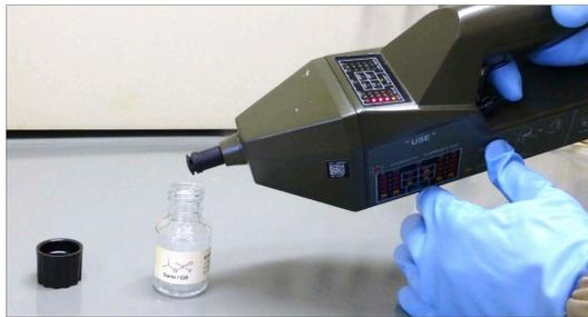
Messung einer Sniff-Probe mit einem Flammenphotometer
