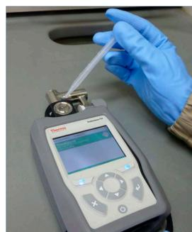
Messung einer Flüssigkeitsprobe mit einem Infrarot-Messgerät
