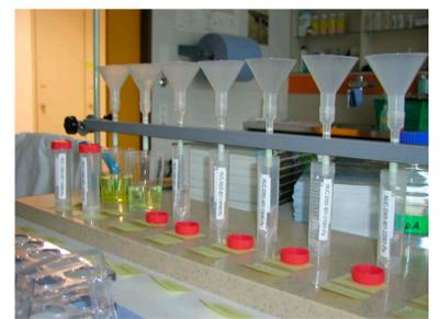
Die Sedimentkerne werden halbiert und im Labor in Zentimeterschichten aufgeteilt. Die Sedimentschichten werden getrocknet und gamma-spektrometrisch gemessen. Die Proben werden anschliessend aufgelöst und einzelne Radionuklide abgetrennt und analysiert.
