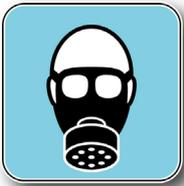
Eine Vollmaske deckt Mund, Nase, Augen und das Kinn des Geräteträgers ab. Die Leistungsanforderungen, die entsprechenden Prüfungen und die Kennzeichnung sind in der Europäischen Norm EN 136 festgelegt.
